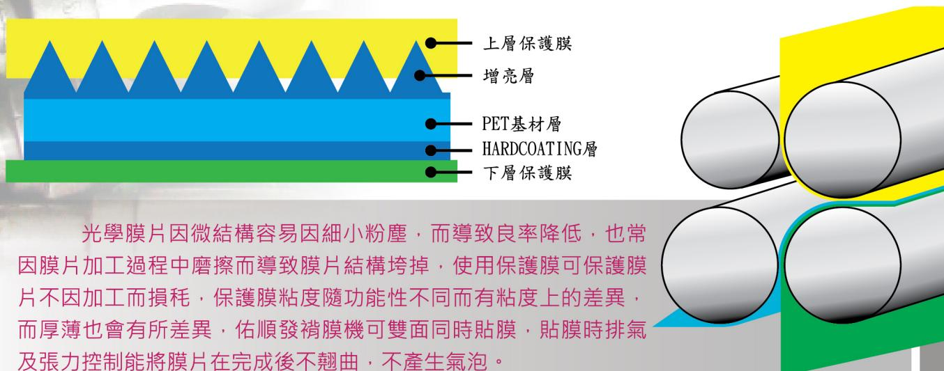
光學膜片因微結構容易因細小粉塵，而導致良率降低，也常因膜片加工過程中磨擦而導致膜片結構垮掉，使用保護膜可保護膜片不因加工而損耗，保護膜粘度隨功能性不同而有粘度上的差異，而厚薄也會有所差異，佑順發滑膜機可雙面同時貼膜，貼膜時排氣及張力控制能將膜片在完成後不翹曲，不產生氣泡。
